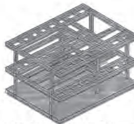
Vivienda en concreto reforzado según la norma NSR10 – estructura mínima.
