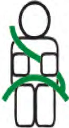
Muy valorado por su efectividad y facilidad de uso, el cinturón abdominal y diagonal de tres puntos es el que se utiliza con mayor frecuencia en automóviles, camionetas, minibuses, camiones y en los asientos de los chóferes de autobuses. La lengüeta del cinturón engarza en la hebilla, que en los asientos delanteros de los automóviles se encuentra generalmente al final de un bastón rígido o directamente fijada al asiento.
