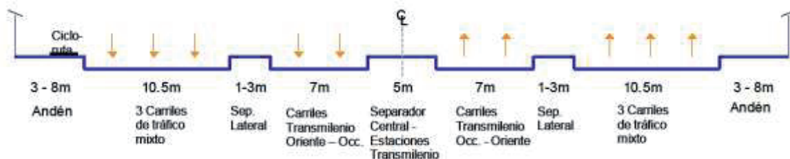
Figura 2. Sección transversal típica de una troncal
