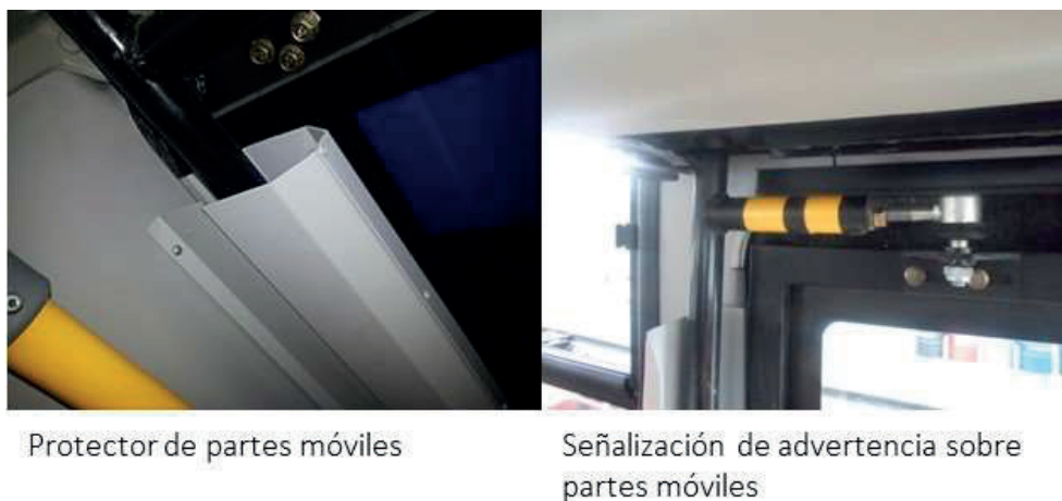
Figura 1. Protecciones y señales para partes móviles
