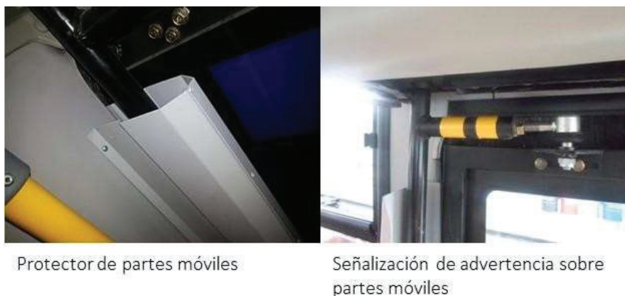
Figura 2 Protecciones y señales para partes móviles - biarticulado
