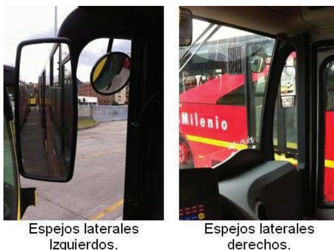
Figura 1 Espejos laterales que deben tener los vehículos biarticulados
