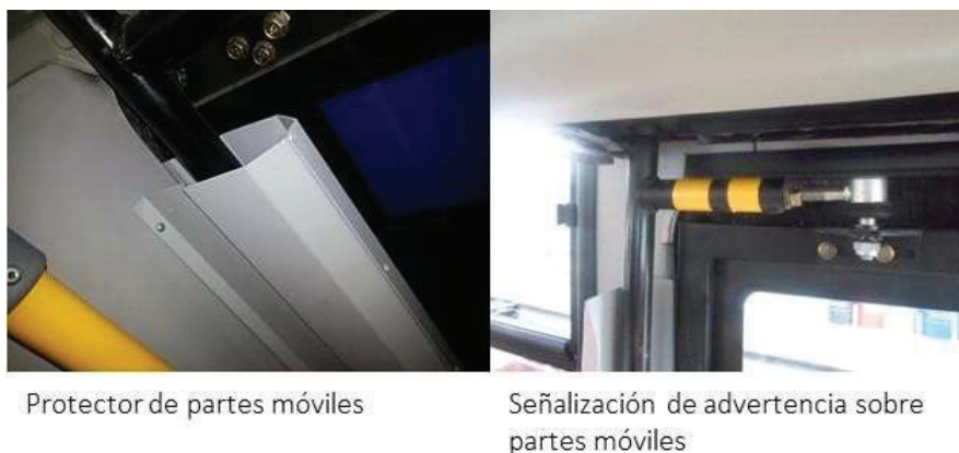
Figura 5 Protecciones y señales para partes móviles - articulado
