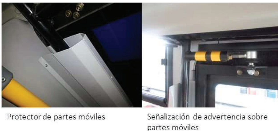
Figura 1. Protecciones y señales para partes móviles
