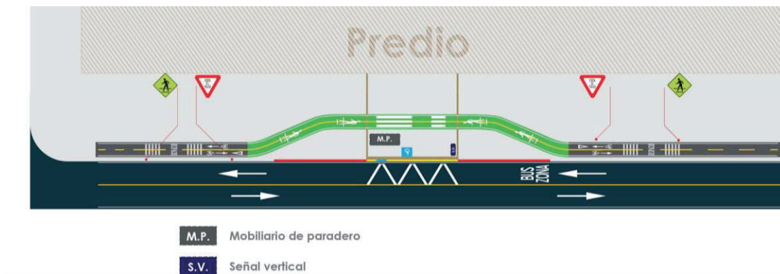
Imagen 40. Paradero con ciclorruta tipo B1 - propuesta señalización Rombo
