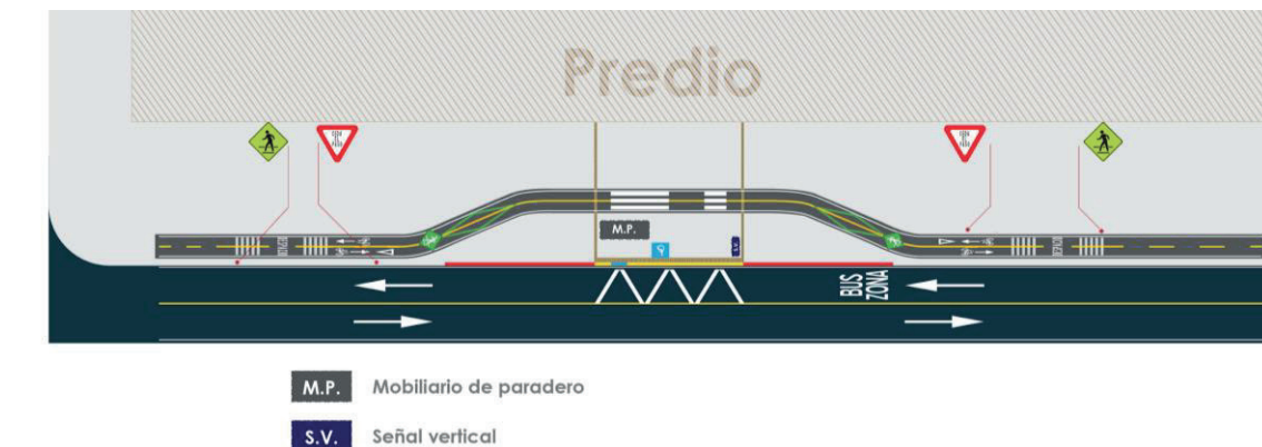
Imagen 40. Paradero con ciclorruta tipo B1 - propuesta señalización Rombo
