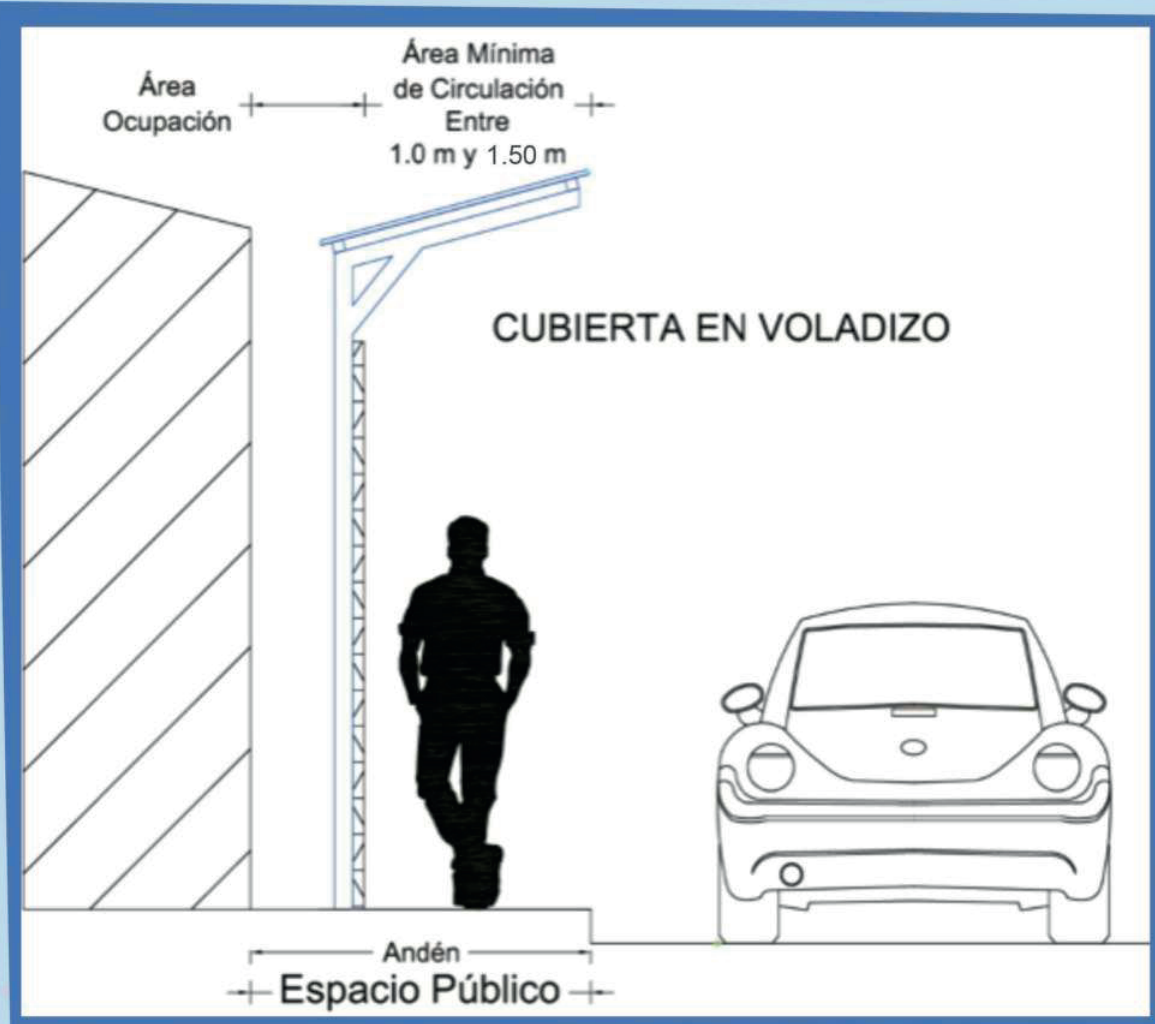
Gráfica 7: Cerramientos en andenes - cubierta en voladizo sobre el área de circulación peatonal.
