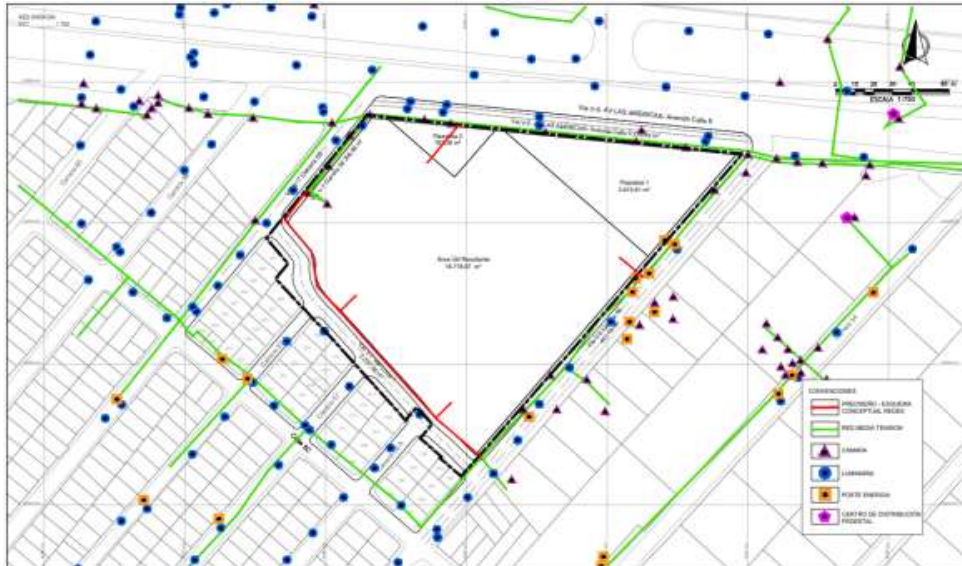
Figura 21. Red de Energía Fuente: Urbanos SAS.
