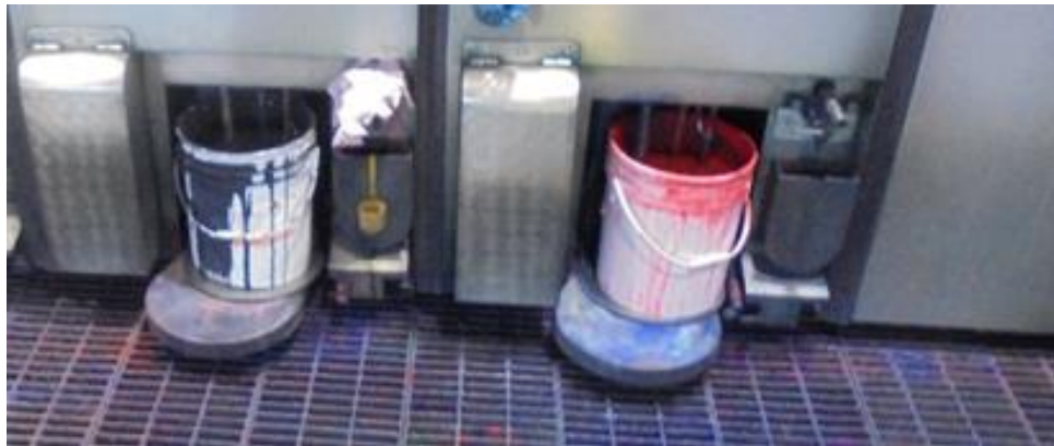
Figura 7 Tintas usadas para imprimir sobre las cajas. Están libres de tóxicos y contaminantes, hay un sistema completo de recuperación de los derrames y residuos y no hay vertimientos industriales. Fuente Taller de Ambiente Humano Sep. de 2019
