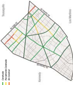
Figura 13: Estado de las Vías
