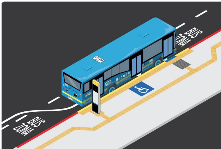
Imagen 25. Proyección paradero con Configuración Tipo B - genérico.
