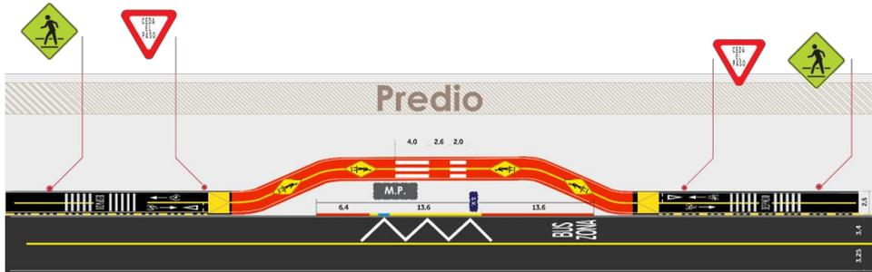
Imagen 46. Paradero con ciclorruta Tipo B2 - propuesta señalización Tapete.
