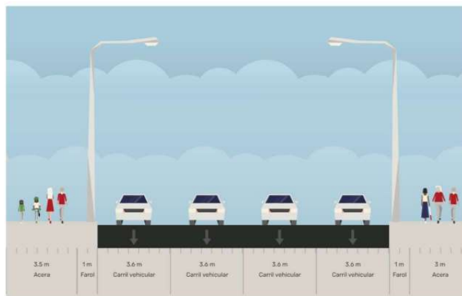
Figura 10. Sección Típica Carrera 13 entre Calle 26-26A
