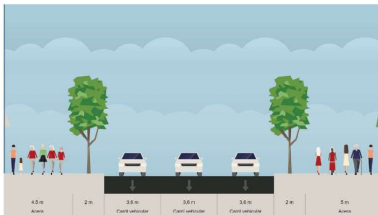
Figura 15. Sección Típica Carrera 13 entre Calle 62-67
