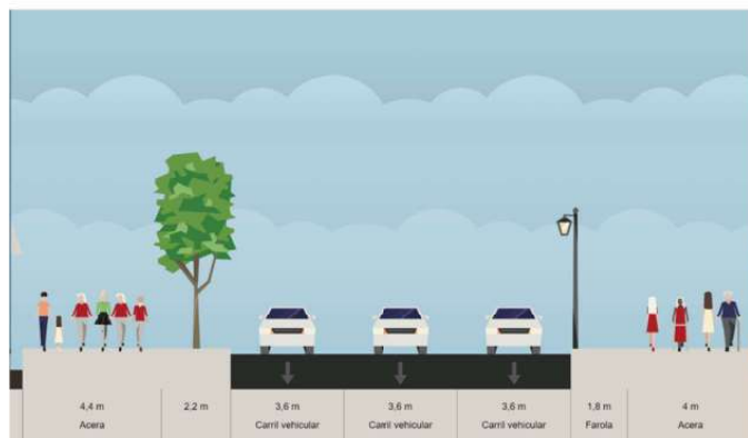
Figura 11. Sección Típica Carrera 13 entre Calle 26A-32
