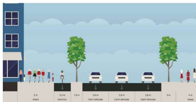
Figura 12. Sección Típica Carrera 13 entre Calle 32-45
