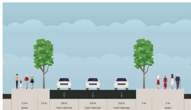
Figura 9. Sección Típica Carrera 13 entre Calle 19-25
