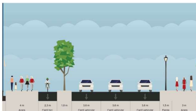
Figura 13. Sección Típica Carrera 13 entre Calle 45-53
