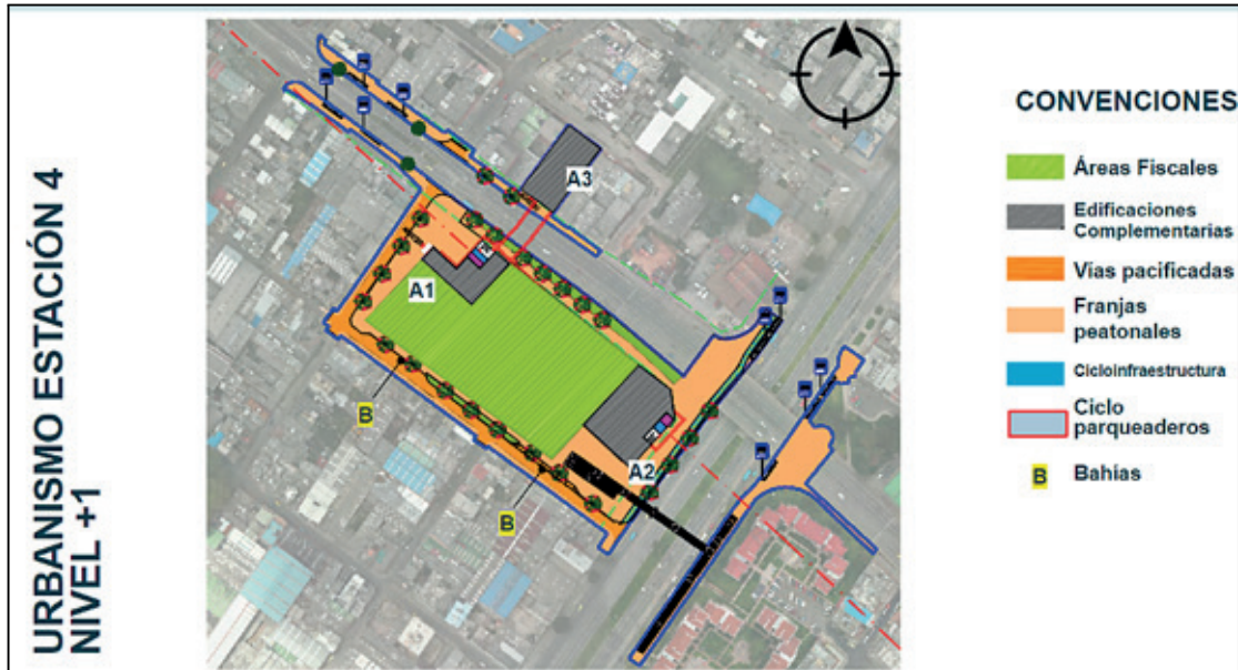
Figura No. 3 Implantación de estaciones y diseño urbanístico estación No. 4 Fuente: UT MOVIUS, 2023
