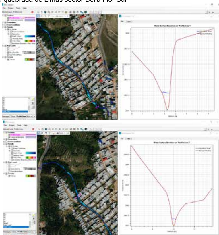
Imagen 21. Secciones transversales de diferentes tramos de la modelación hidráulica del Drenaje Afluente 2 de la quebrada de Limas sector Bella Flor Sur
