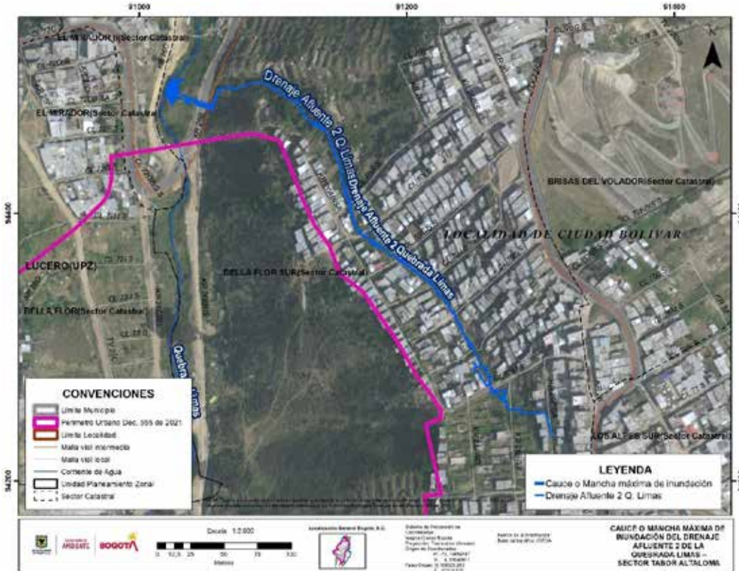
Imagen 90. Mancha máxima de inundación TR 100 del Drenaje Afluente 2 de la quebrada de Limas
