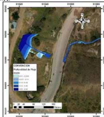
Imagen 18. Desbordamiento Margen Izquierdo Drenaje 2 quebrada Limas Tr 100 años.
