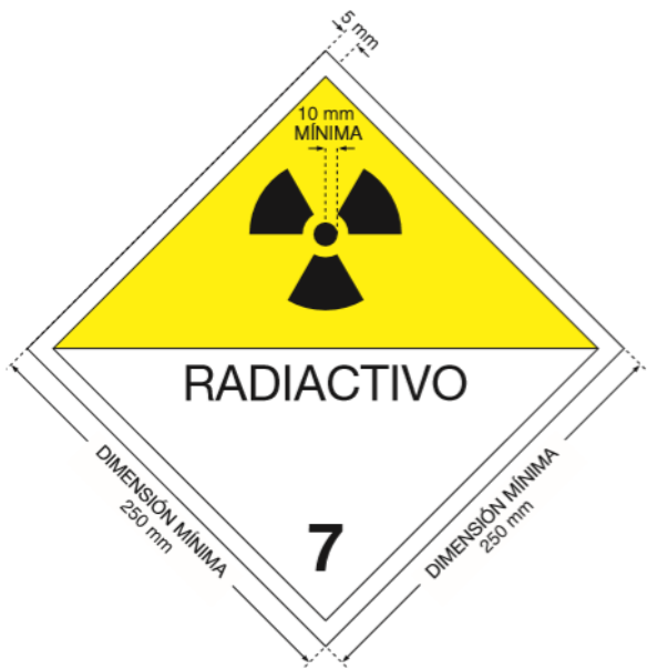
Figura 6: Rotulado. Salvo en los casos permitidos en virtud de lo establecido en el artículo 70, las dimensiones de este modelo son las mínimas; cuando se utilicen rótulos de distintas dimensiones deben guardarse las mismas proporciones que en el modelo. El número “7” tendrá una altura no inferior a 25 5mm El color de fondo de la mitad superior del rótulo será amarillo y el de la mitad inferior blanco, el trébol y los caracteres y líneas impresos serán negros. El empleo del término “RADIOACTIVO” en la mitad inferior es facultativo, con el fin de permitir también la utilización de este rótulo para indicar el número apropiado de las Naciones Unidas correspondiente a la remesa
