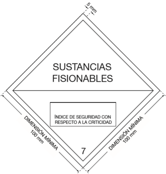
Figura 5: Etiqueta para el ISC. La anchura mínima de la línea dentro del borde que forma el rombo será de 2 mm. El color de fondo de la etiqueta será blanco y los caracteres y líneas impresos serán negros
