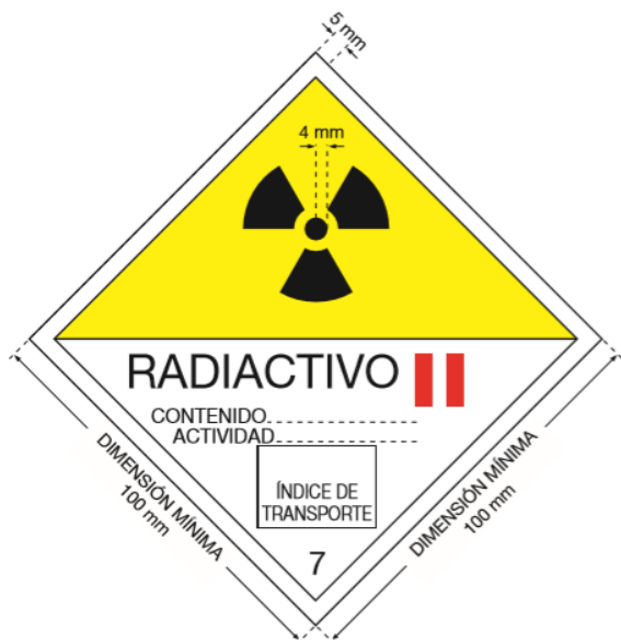
Figura 3: Etiqueta para la categoría II-AMARILLA. La anchura mínima de la línea dentro del borde que forma el rombo será de 2 mm. El color de fondo de la mitad superior de la etiqueta será amarillo y el de la mitad inferior, blanco, el trébol y los caracteres y
