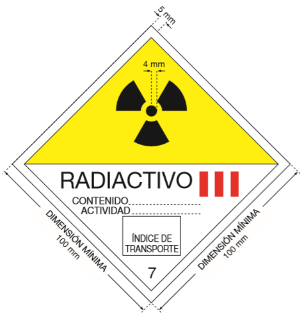
Figura 4: Etiqueta para la categoría III-AMARILLA. La anchura mínima de la línea dentro del borde que forma el rombo será de 2 mm. El color de fondo de la mitad superior de la etiqueta será amarillo y el de la mitad inferior, blanco, el trébol y los caracteres y las barras que indican la categoría serán rojas
