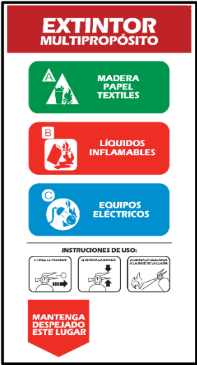
Ilustración 10. Ejemplo de rotulación de extintores
