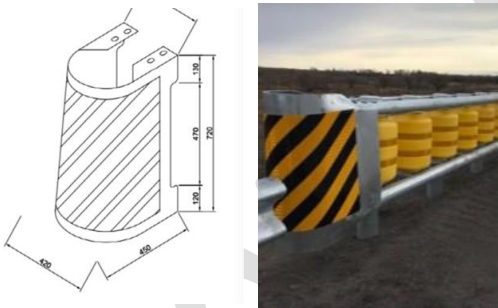
Figura 732-1 Modelo ejemplo de Terminal del Sistema de Barrera de Rodillos – Dimensiones ejemplo en milímetros
